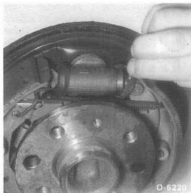
**Achtung:** Falls die Bremsstrommel abgebaut wurde, Manschette Radbremszylinder zurückziehen und auf Feuchtigkeit hinter der Manschette prüfen. Gegebenenfalls Radbremszylinder austauschen.
