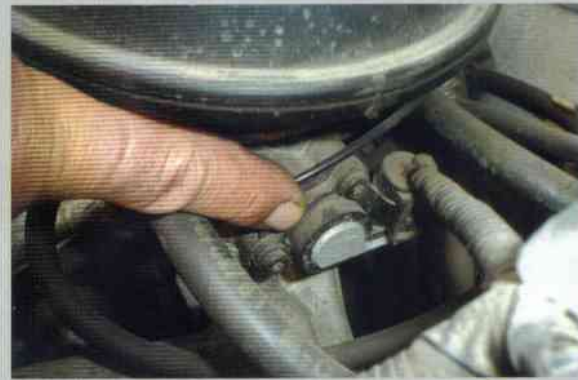
SENSOR DE LA POSICIÓN DE LA MARIPOSA (TPS):
