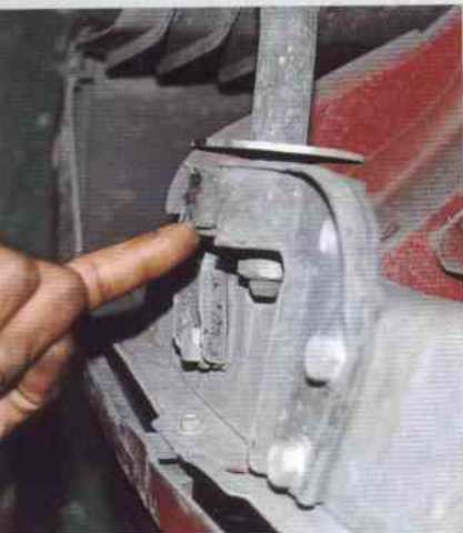
En esta foto te mostramos la ubicación del hidrobush.
