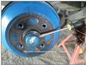
2.- Retiramos con una pinza el reten que asegura la tuerca que posteriormente sacamos con un Rach y el dado # (debo colocarlo):
