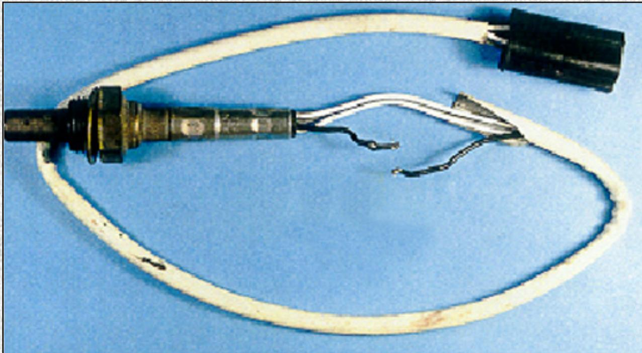
La sonda debe ser sustituida
