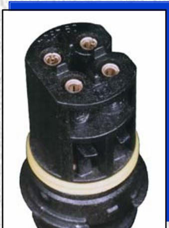
**Importante** - solo una conexión original transmite correctamente a la unidad de control del motor el valor de tensión adecuado de la sonda lambda.
