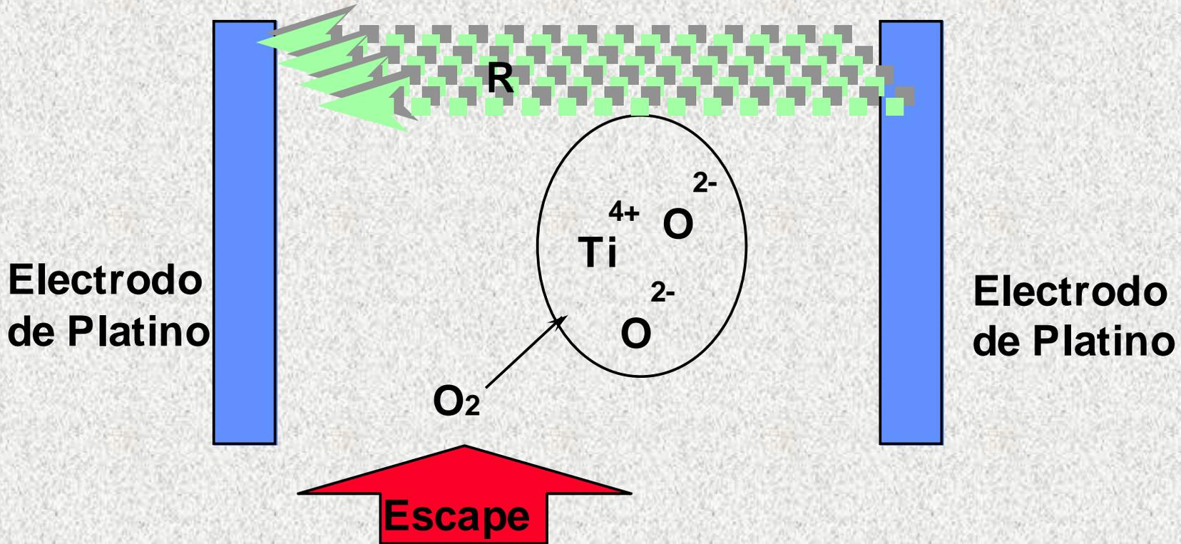
La resistencia  $R$  entre los electrodos desciende con un gas de escape rico ya que mas iones libres de oxigeno procedentes del titanio reaccionan con el gas de escape.
